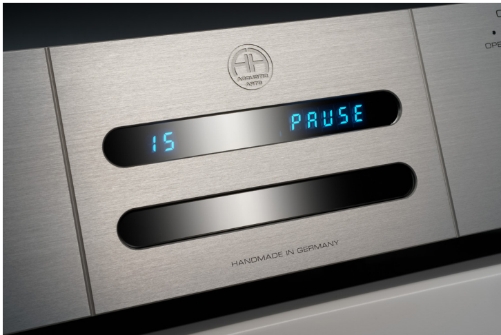
Unter der Gravur des Firmenemblems sind zwei spiegelnde Blenden eingelassen, die erst im Betrieb offenbaren, was hinter ihnen steckt. Hinter der oberen sitzt das schmale Display, es präsentiert mit LED-Segmentanzeigen die wichtigen Infos.
