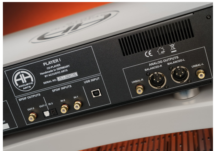
Der Player I bietet etliche Anschlussmöglichkeiten: Eingangsseitig offeriert er einen USB-Port und drei S/PDIF-Inputs. Ausgangsseitig bietet er analog einen symmetrischen XLR- und einen unsymmetrischen Cinch-Anschluss, digital kommen noch ein elektrischer und ein optischer S/PDIF Out hinzu.
