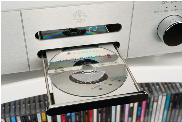
Hinter der unteren Blende sitzt das Frontloader-Laufwerk des Player I. Die Lade ist durch zwei seitliche Führungsschienen zusätzlich stabilisiert. Auch dadurch gelingt das Rein- und Rausfahren mit einer tollen Geschmeidigkeit und Ruhe.
