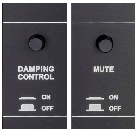
An der Endstufe lassen sich Dämpfungslinearisierung sowie Mute einstellen.
