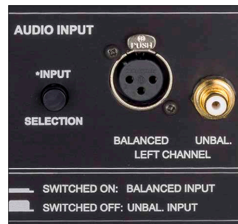
Die ebenfalls sehr hochwertigen Cinch- und XLR-Eingangsbuchsen sind umschaltbar.
