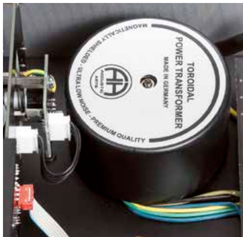
Ein gekapselter Ringkerntrafo speist den Preamp III. Er sitzt links vorne im Gehäuse und somit weit von den empfindlichen Eingängen entfernt.
