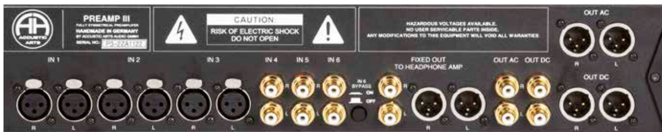
Mit sechs Hochpegel- sowie insgesamt vier Endstufenausgängen zeigt sich der Accustic Arts kontaktfreudig. Die unregulierten Outputs sind oft ebenfalls praktisch.
