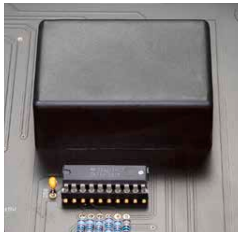
In dieser unscheinbaren Blackbox befindet sich die hochpräzise, wie der gesamte Preamp III voll-symmetrisch ausgelegte Lautstärkeregelung.
