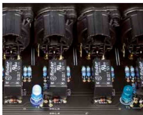
Die Eingänge werden über gasdichte Relais geschaltet. Die zugeordneten blauen LEDs sieht man durch den Gehäusedeckel glimmen.
