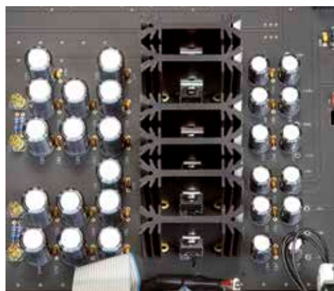
Gleich sechs individuelle Spannungsstabilisierungen verhindern die gegenseitige Beeinflussung der Audio- und sonstigen Kreise der Vorstufe.
