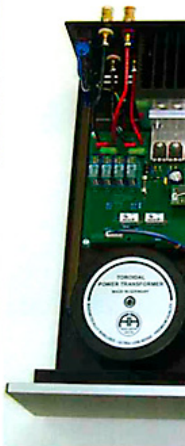
600VA的高效率多绕组密封式防磁漏环型变压器
