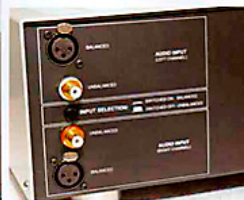
同时备有平衡及非平衡输入端子
