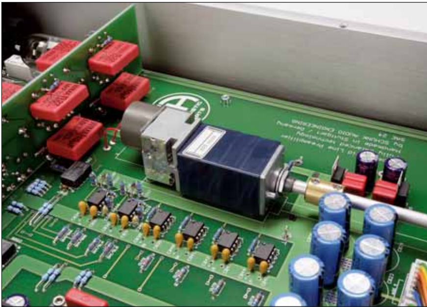
Das Vierfach-Poti besorgt die vollsymmetrische Pegelinstellung, die Reihe Chips davor bildet die Ausgangsverstärker
