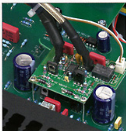
Feine Kabel kommen zwischen Buchsen und Eingangsstufe zum Einsatz
