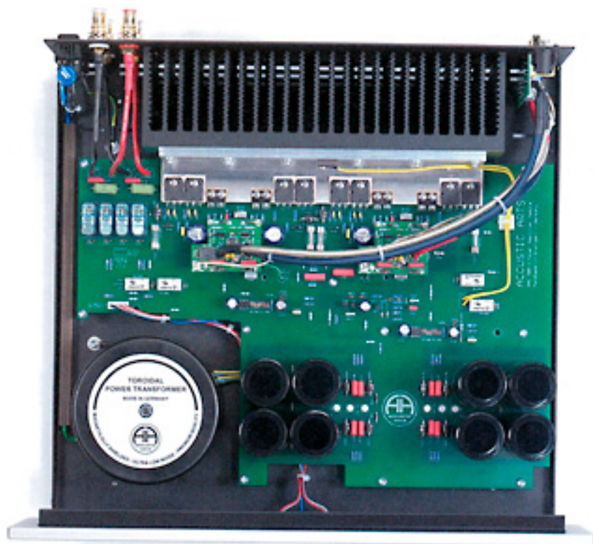
Die Sekundärwicklungen des Trafos versorgen getrennte Netzteilsektionen
