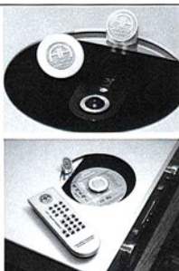
△ Drive 1 MK2 的頂蓋開啟後，可見黑色絨面的碟倉，有利吸音。精緻的 CD 底座，手工一流。操控的手感及外型也不差。
